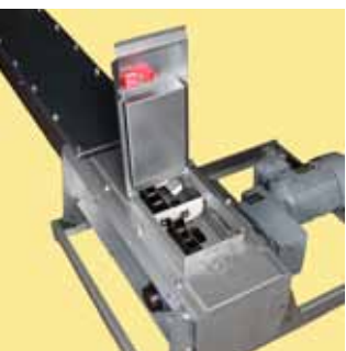
Överfyllnads-/ inspektionslucka med säkerhetsbrytare.
