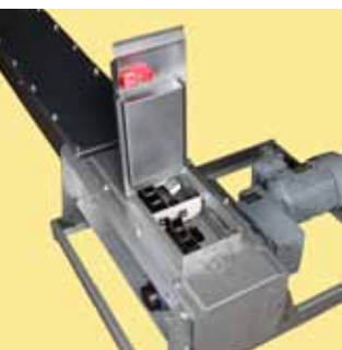
Överfyllnads-/ inspektionslucka med säkerhetsbrytare.
