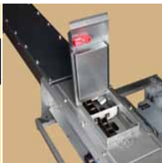
Överfyllnads-/inspektionsslucka med säkerhetsbrytare.
