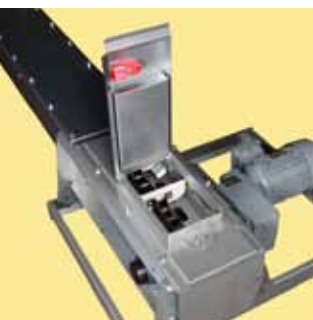
Överfyllnads-/ inspektionslucka med säkerhetsbrytare.
