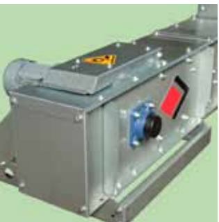
Överfyllnads-/inspektionsslucka med säkerhetsbrytare.
