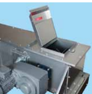
Överfyllnads-/inspektionslucka med säkerhetsbrytare.
