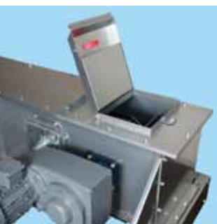
Överfyllnads-/inspektionslucka med säkerhetsbrytare.
